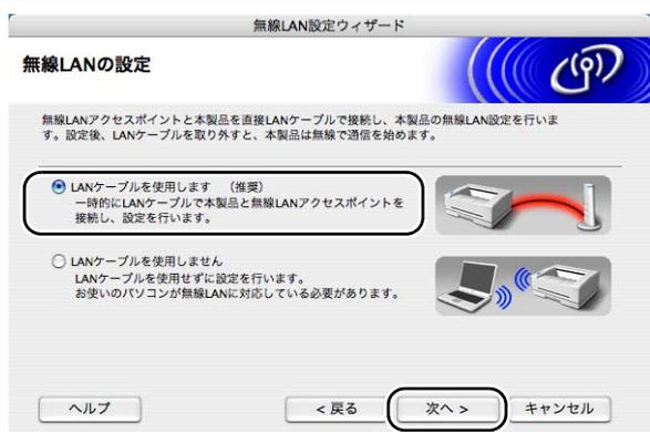
**8** LAN ケーブルで本製品を無線LANアクセスポイントに接続し、[次へ] をクリックする
