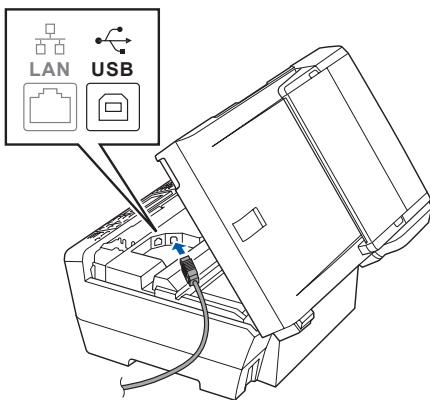
(3) USBケーブルを本製品の溝におさめ、MacintoshにUSBケーブルを接続する
