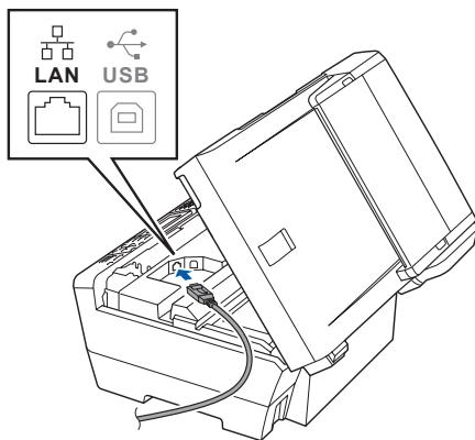
(3) LAN ケーブルを本製品の溝におさめ、ハブまたはルータの LAN ポートに LAN ケーブルを接続する
