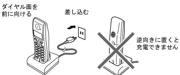
充電器に子機をセットすると画面に「ジュウデンチュウ」と表示され、[■] が点滅し、充電ランプが点灯します。
