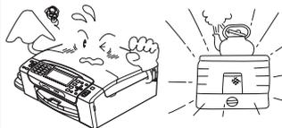
● 電源コードのホコリなどは定期的にとってください。湿気などで絶縁不良の原因となります。電源コードをコンセントから抜き、乾いた布でふいてください。
