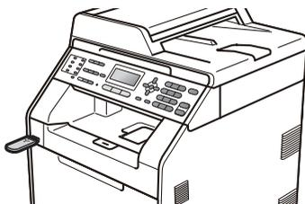
※本製品がデープスリープモードのときは、USBメモリを接続しても<USBダイレクト>は青く点灯しません。<OK>を押してから、USBメモリを接続してください。
