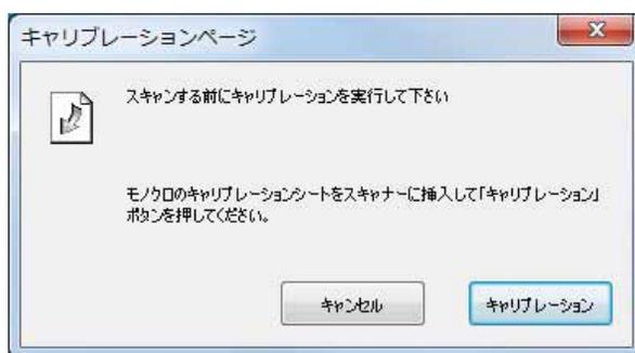
このキャリブレーションプロセスではスキャナーに同梱の特殊なモノクロのキャリブレーションシート（ページ iv の図を参照）を使用します。キャリブレーションの際には、矢印の方向に注意して正しく挿入してください。「キャリブレーション」ボタンを押して、キャリブレーションを実行してください。
