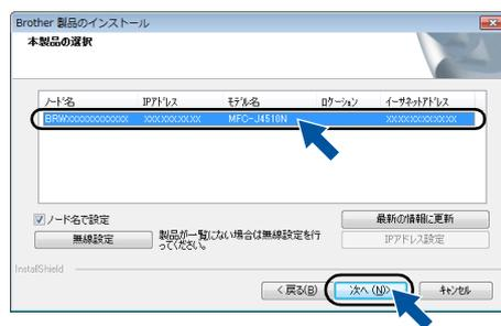
画面の IP アドレス欄に APIPA と表示された場合は、[IP アドレス設定] をクリックし、お使いのネットワーク上で本製品の IP アドレスを入力します。IP アドレスなどを調べるときは、「ネットワーク設定リスト」を印刷します。
