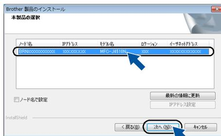
画面の IP アドレス欄に APIPA と表示された場合は、[IP アドレス設定] をクリックし、お使いのネットワーク上での本製品の IP アドレスを入力します。IP アドレスなどを調べるときは、「ネットワーク設定リスト」を印刷します。
