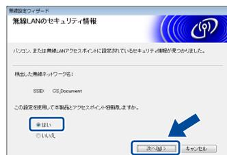
**i** 無線設定ウィザードが、本製品と接続可能な無線 LAN を検索します。18 ページの手順 **11-a** に記入した SSID を選び、**次へ**をクリックします。
