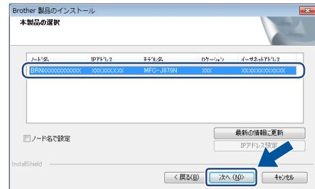
画面の IP アドレス欄に APIPA と表示された場合は、[IP アドレス設定] をクリックし、お使いのネットワーク上でこの本製品の IP アドレスを入力します。IP アドレスなどを調べるときは、「ネットワーク設定リスト」を印刷します。
