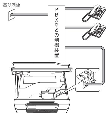
PBX などの制御装置がナンバー・ディスプレイに対応していない場合は「ナンバー・ディスプレイサービス」がご利用になれます。【特別回線対応】の設定を【PBX】に設定すると、本製品の【ナンバーディスプレイ】の設定は自動的に【なし】になります。
