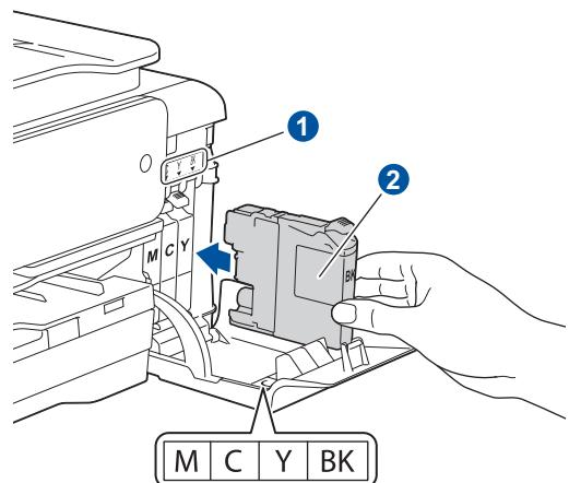
インクカートリッジのラベルに、挿入方向を示す矢印とインク色が印刷されています。
