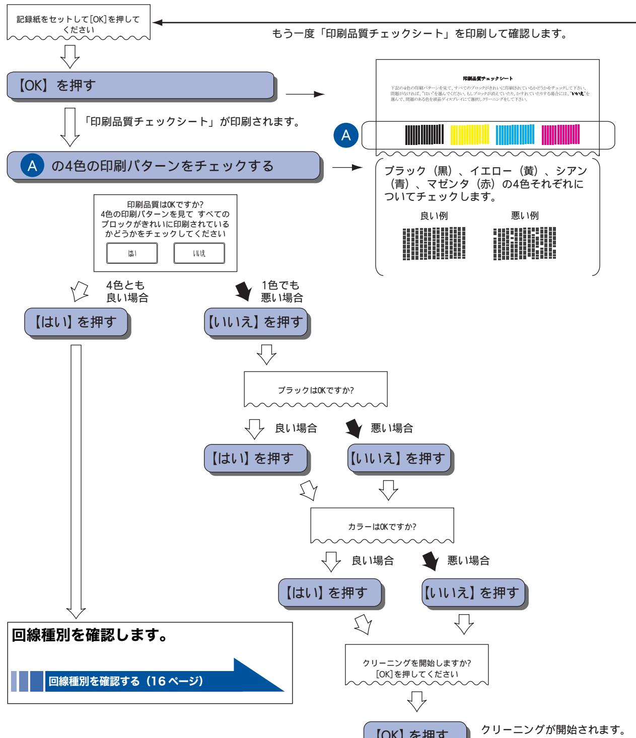
クリーニングを繰り返しても印刷品質が悪い場合は、3~5時間放置したあとで、再度「印刷品質チェックシート」を印刷してみてください。
