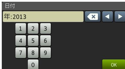
5 月（2桁）を画面に表示されているテンキーを使用して入力し、【OK】を押す
