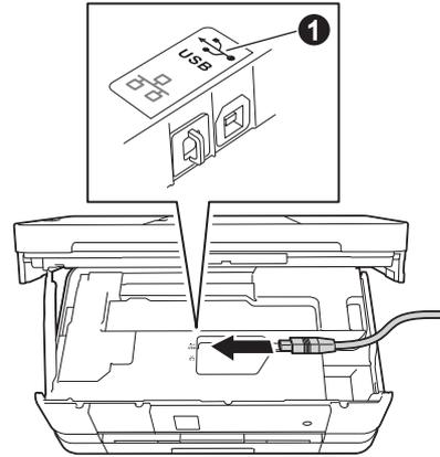
**c** Guidez soigneusement le câble USB dans la rainure spéciale en le faisant sortir par l'arrière de l'appareil. Connectez le câble au Macintosh.
