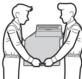
При использовании нижнего лотка НЕ следует переносить аппарат с нижним лотком, так как он не прикреплен к аппарату, а это может привести к травме или повреждению аппарата.
