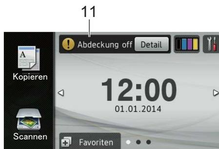
Das Warnsymbol ! erscheint bei einer Fehlermeldung oder einer Wartungsmeldung; drücken Sie *Detail*, um die Meldung anzuzeigen und drücken Sie dann
