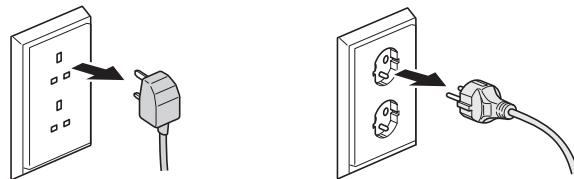
لا تستخدم كبل طاقة التيار المتردد لسحب أو دفع القابس بمقبس التيار الكهربائي بالحائط واستخدم مسكات الأصابع على القابس.
