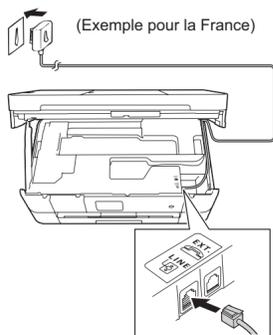
Branchez le cordon de ligne téléphonique. Utilisez la prise **LINE** et faites ressortir le cordon par l'arrière de l'appareil.
