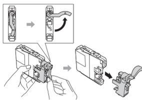
Следвайте инструкциите на сензорния екран, за да инсталирате мастилниците. Устройството ще подготви системата за провеждане на мастилото за печатане.
