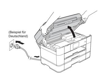
Schließen Sie das Netzkabel an. Öffnen Sie den Gehäusedeckel des Gerätes
