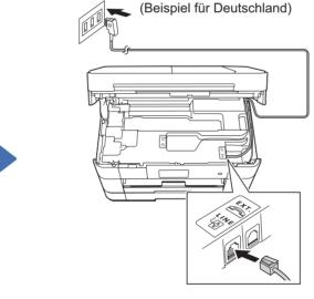
Schließen Sie das Faxanschlusskabel an. Verwenden Sie die mit LINE beschriftete Buchse und führen Sie das Kabel an der Geräterückseite heraus.
