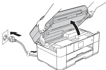
Ligue o cabo de alimentação. Levante a tampa do digitalizador.
