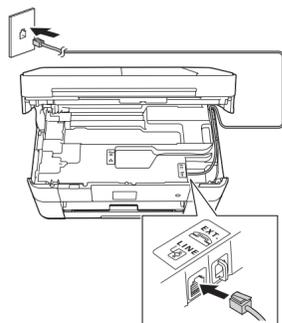
Ligue o fio da linha telefónica. Utilize a tomada com a indicação **LINE** e passe o cabo para fora da parte de trás do equipamento.
