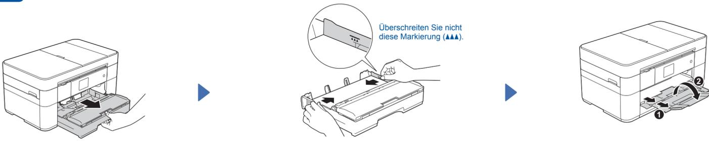
Ziehen Sie die Papierkassette vollständig aus dem Gerät.
