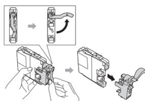
Siga as instruções do ecrã tátil para instalar os cartuchos de tinta. O equipamento irá preparar o sistema de tinta para a impressão.
