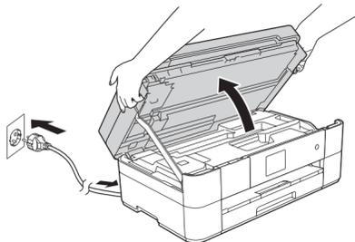
Conecte el cable de alimentación. Levante la cubierta del escáner.
