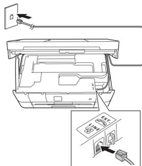
Conecte el cable de línea telefónica. Utilice la entrada denominada **LINE** y guíe el cable hacia la parte posterior del equipo.
