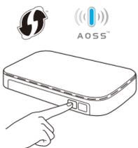
Drücken Sie die WPS- oder AOSS™-Taste am WLAN-Access Point/Router.
