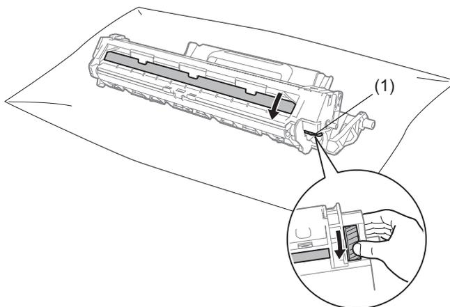
用乾的棉花棒輕輕擦拭感光滾筒表面，直到去除表面的灰塵或黏著物為止。
