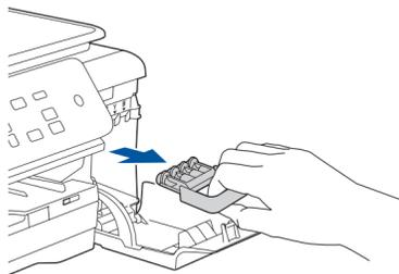
インクカートリッジの保護カバーを外します。インクカートリッジの基板 ① に触れないでください。本製品がインクカートリッジを検知できなくなるおそれがあります。
