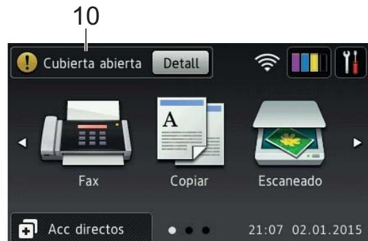
El icono de advertencia ! aparece cuando se genera un mensaje de error o de mantenimiento; pulse `Detall` para ver el mensaje y, a continuación, pulse
