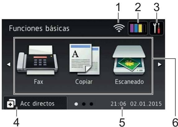
La pantalla Funciones básicas muestra la fecha y la hora y permite acceder a los modos Fax, Copiar y Escaneado.
