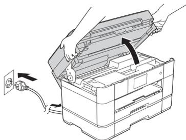
Conecte el cable de alimentación. Levante la cubierta del escáner.
