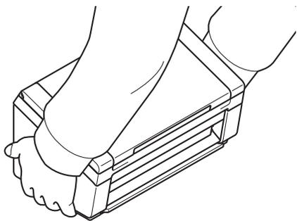
Utilice el equipo con cuidado para evitar que la ropa (especialmente las mangas, las corbatas, etc.), el pelo u otros accesorios sean tragados por el equipo, ya que podría lesionarse. En caso de que un objeto sea tragado por el equipo, desconecte de inmediato la unidad de la fuente de alimentación.
