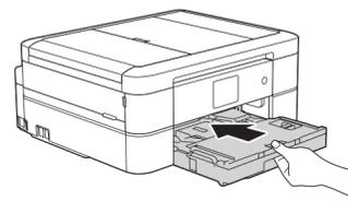
Cierra la cubierta de la bandeja de salida y empuje la bandeja con cuidado para introducirla en el equipo.
