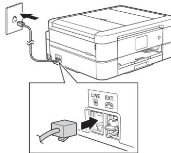
Conecte el cable de línea telefónica. Utilice la entrada denominada **LINE**.
