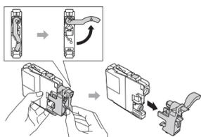
Siga las instrucciones de la pantalla táctil para instalar los cartuchos de tinta. El equipo preparará el sistema de tubos de tinta para la impresión.
