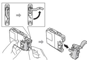
Siga as instruções do ecrã para instalar os cartuchos de tinta. O equipamento irá preparar o sistema de tinta para a impressão.
