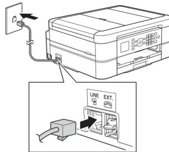
Ligue o fio da linha telefónica. Utilize a tomada com a indicação **LINE**.
