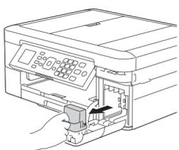
Abra a tampa do cartucho de tinta e retire a peça de proteção laranja do equipamento.
