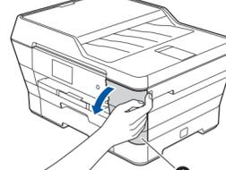
画面の指示に従って、インクカートリッジを取り付けます。プリントヘッドのクリーニングが行われます。
