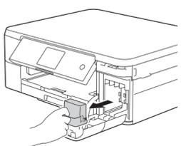
Öffnen Sie die Tintenpatronen-Abdeckung und entfernen Sie dann den orangefarbenen Transportschutz vom Gerät.
