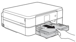
Ziehen Sie die Papierkassette vollständig aus dem Gerät.
