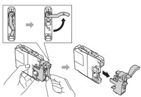
Seguire le istruzioni visualizzate sul touchscreen per installare le cartucce d'inchiostro. L'apparecchio prepara per la stampa il sistema dei tubi dell'inchiostro.
