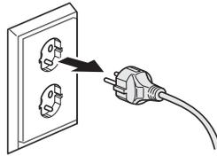
NÃO utilize o cabo de alimentação CA para puxar a ficha para fora da tomada eléctrica, nem para a empurrar para dentro da tomada de parede; utilize as pontas dos dedos na própria ficha.
