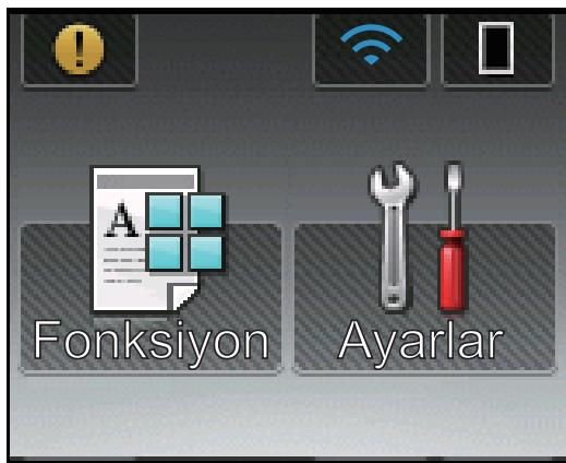
Bir hata ya da bakım mesajı olduğunda uyarı simgesi görünür; bunu görüntülemek için öğesine basın ve sonra Hazır Moduna dönmek için öğesine basın.
