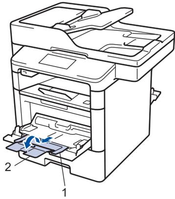
5. Fare scorrere le guide laterali del vassoio MP in modo da adattarle alla larghezza della carta utilizzata. Se le guide della carta sul lato destro sono dotate di leva, premere la leva e far scorrere le guide.
