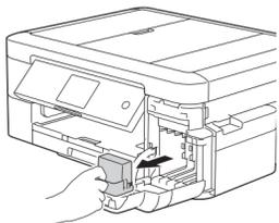
Ouvrez le couvercle de la cartouche d'encre puis retirez l'élément de protection orange de l'appareil.
