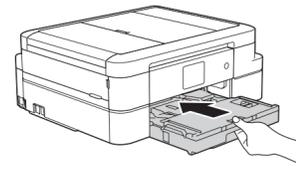
Fermez le capot du bac de sortie, puis poussez lentement le bac complètement dans l'appareil.
