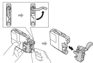
Seguire le istruzioni visualizzate sul touchscreen per installare le cartucce d'inchiostro. L'apparecchio prepara per la stampa il sistema dei tubi dell'inchiostro.
