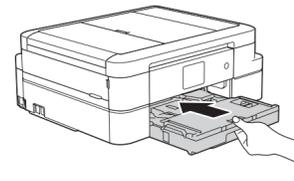
Chiudere il coperchio del vassoio uscita carta e, lentamente, premere completamente il vassoio nella macchina.
