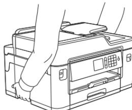
عند حمل الجهاز، ازّع الدروع في حال اطلالها لاحتواء قياسات الورق الكبيرة مثل Ledger، أو A3، أو Legal أو Folio. قد يتسبّب وزن الورق في سقوط الدروع وأصابائك.
