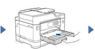
Mettez en place le couvercle supérieur du bac, puis poussez lentement le bac à papier à fond dans l'appareil.
