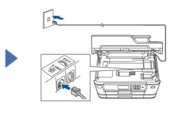
Branchez le cordon téléphonique. Utilisez la prise **LINE** et placez le cordon dans la rainure prévue à cet effet pour le guider vers l'arrière de l'appareil.
