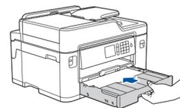
Mettez en place le couvercle supérieur du bac, puis poussez lentement le bac à papier jusqu'au fond dans l'appareil.
