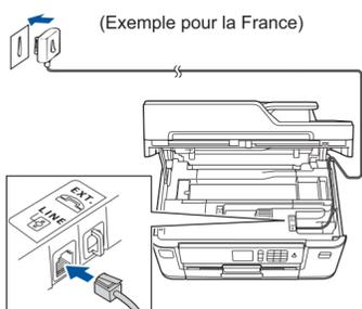
Branchez le cordon de ligne téléphonique. Utilisez la prise appelée **LINE** et faites ressortir le cordon par l'arrière de l'appareil.
