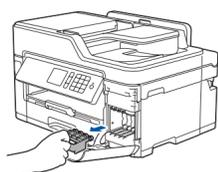
Abra la cubierta de los cartuchos de tinta y saque la pieza naranja de protección del equipo.
