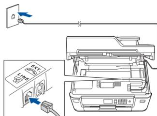
Conecte el cable de línea telefónica. Utilice la toma denominada **LINE** y dirija el cable por la parte trasera del equipo.
