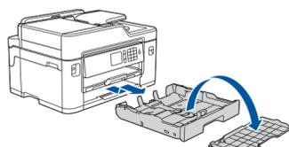
Extraiga la bandeja de papel completamente del equipo tal y como muestra la flecha. Extraiga la cubierta superior de la bandeja.
