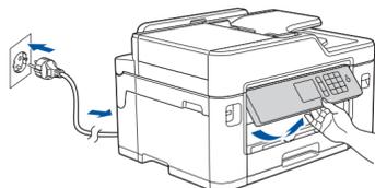
Conecte el cable de alimentación. El equipo se encenderá automáticamente.
