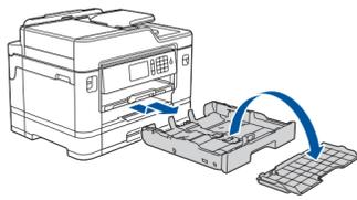
Extraiga la bandeja de papel completamente del equipo tal y como muestra la flecha. Extraiga la cubierta superior de la bandeja.
