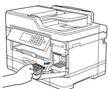
Abra la cubierta de los cartuchos de tinta y saque la pieza naranja de protección del equipo.
