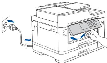
Conecte el cable de alimentación. El equipo se encenderá automáticamente.
