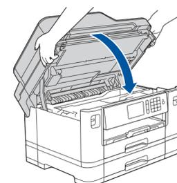
Baje la cubierta del escáner.
