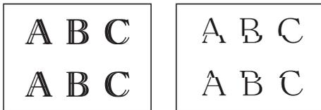
Una volta regolato correttamente l'allineamento di stampa, il testo appare come in questo esempio.
