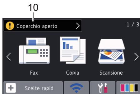
L'icona di avvertimento appare quando si verifica un errore o un messaggio di manutenzione; premere per visualizzare i dettagli, quindi premere per tornare in modalità Ready
