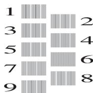
**6** Per lo schema "A", scorrere rapidamente verso l'alto o il basso oppure premere ▲ o ▼ per visualizzare il numero della prova di stampa con le linee verticali meno visibili (1-9), quindi selezionarlo (nell'esempio riportato, il numero 6 rappresenta la scelta ottimale). Premere [OK].
