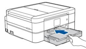
Schließen Sie die Abdeckung der Papierablage, und schieben Sie die Kassette vollständig in das Gerät.
