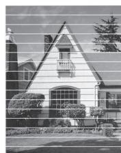
После прочистки этого сопла горизонтальные линии исчезают.
