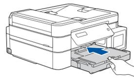
Fermez le capot du bac de sortie, puis poussez lentement le bac jusqu'au fond dans l'appareil.
