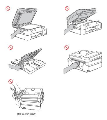
Ne touchez PAS les bords des pièces métalliques derrière les rouleaux dans la zone grisée indiquée sur l'illustration. Les bords de ces pièces sont tranchants et le fait de toucher les pièces métalliques derrière les rouleaux peut entraîner des coupures ou autres blessures au niveau de vos doigts.
