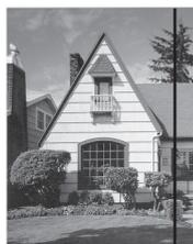
Quando há uma mancha de sujeidade ou de líquido corretor no vidro, a amostra digitalizada apresenta uma linha vertical.
