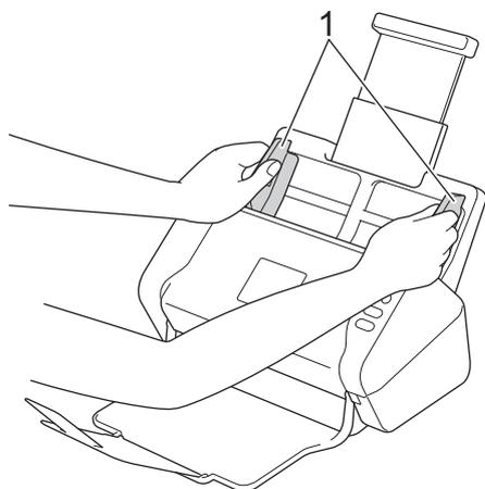
3. Coloque a folha de transporte no ADF, *virada para baixo*, entre as guias de papel até a sentir tocar no interior do equipamento.
