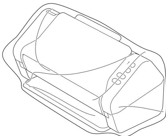
5. Coloque o equipamento e os materiais impressos na caixa de cartão original com o material de embalagem original, conforme ilustrado.
