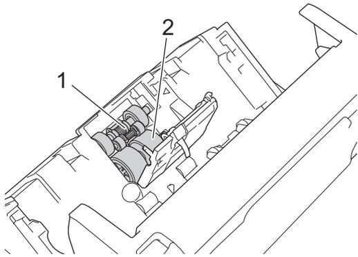
5. Instale o novo rolo de recolha inferior na abertura e faça-o deslizar para a esquerda no eixo.
