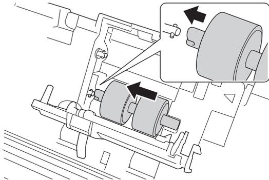
6. Instale o novo rolo de recolha superior na abertura e faça-o deslizar para a esquerda no eixo.
