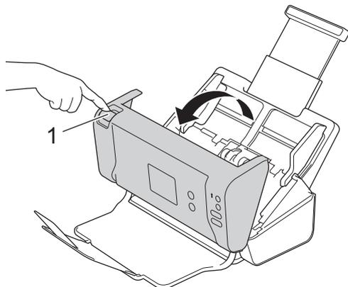
2. Enquanto pressiona o lado esquerdo da tampa do rolo travão (1) a partir da parte traseira do equipamento, puxe a tampa para baixo.
