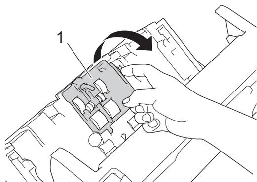
4. Faça deslizar o rolo de recolha superior (1) para a direita e puxe-o para fora para o retirar. Retire o rolo de recolha inferior (2) da mesma forma.
