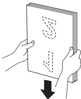
4. Coloque o documento, *virado para baixo* e com a *margem superior primeiro* no ADF, entre as guias de papel, até o sentir tocar no interior do equipamento. Alimente páginas finas de forma lenta e cuidadosa para evitar que a margem fique dobrada.
