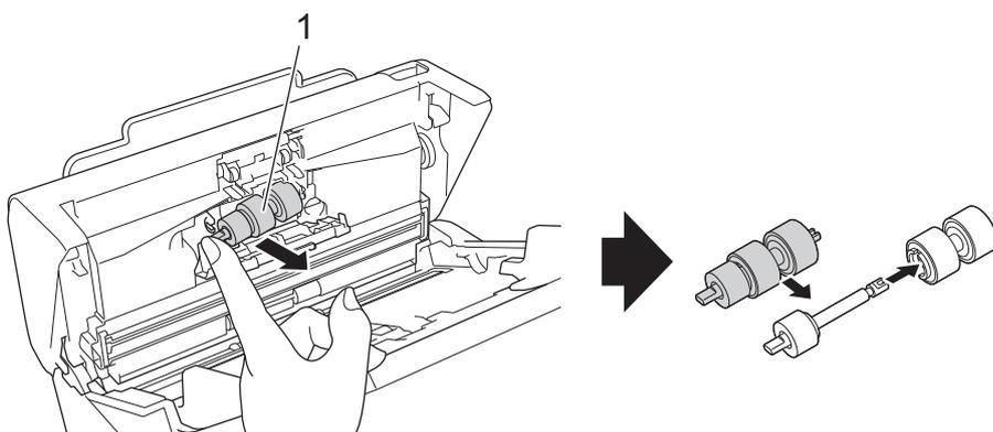
4. Instale o eixo do novo rolo travão (1) na ranhura na abertura e introduza o rolo travão no equipamento.
