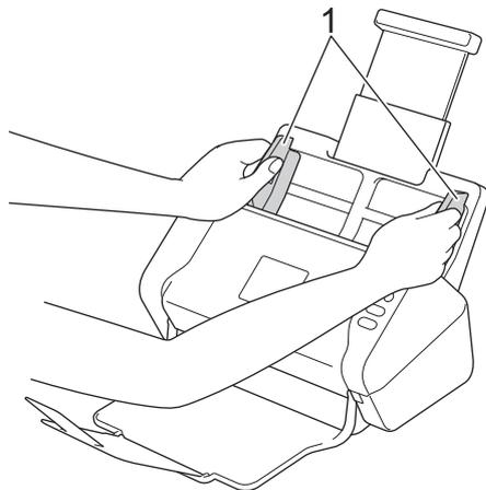
2. Coloque o documento, *virado para baixo* e com a *margem superior primeiro* no ADF, entre as guias de papel, até o sentir tocar no interior do equipamento.
