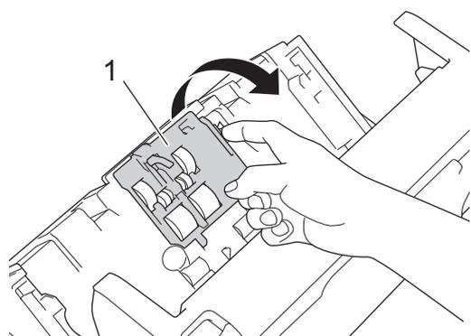
4. Desplace el rodillo de recogida superior (1) hacia la derecha y luego sáquelo para retirarlo. Retire el rodillo de recogida inferior (2) de la misma forma.
