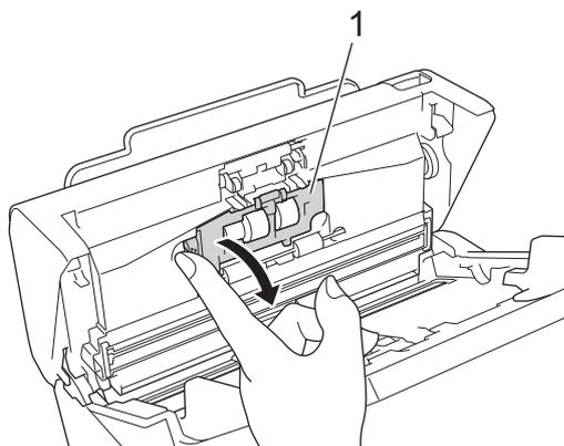
3. Levante el eje del rodillo de freno (1) con el dedo para quitar el rodillo.
