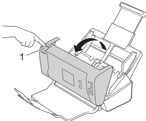
2. Al tiempo que empuja la parte izquierda de la cubierta del rodillo de freno (1) de la parte posterior del equipo, empuje la cubierta hacia abajo.
