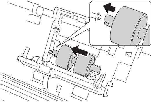
6. Coloque el nuevo rodillo de recogida superior en la abertura y luego desplácelo hacia la izquierda hasta el eje.
