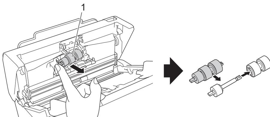
4. Coloque el eje del nuevo rodillo de freno (1) en la ranura en la abertura e inserte el rodillo de freno en el equipo.
