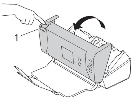
3. Al tiempo que empuja la parte derecha de la cubierta del rodillo de recogida (1) de la parte delantera del equipo, empuje la cubierta hacia abajo.
