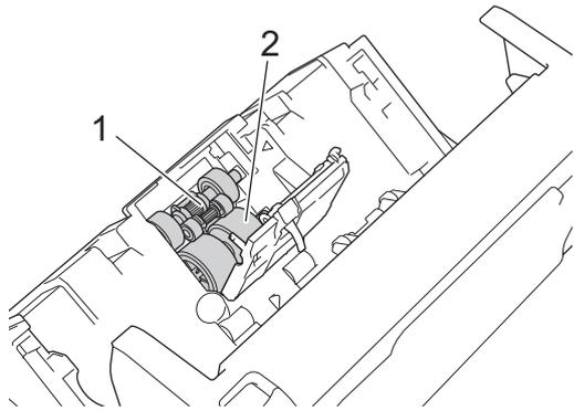
5. Coloque el nuevo rodillo de recogida inferior en la abertura y luego desplácelo hacia la izquierda hasta el eje.
