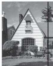
Si hay suciedad o corrector líquido en la banda del cristal, en la prueba de escaneado aparecerá una línea vertical.
